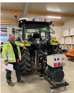
Damit bei flächendeckenden, mehrtägigen Stromausfällen die kritische Infrastruktur bestmöglich aufrechterhalten werden kann, hat der Gemeindevorstand den Ankauf eines Notstromaggregates beschlossen. Um für eine Aufrechterhaltung der Stromversorgung in Notfällen gerüstet zu sein, wurde dieser mobile Zapfwellenstromerzeuger von unseren Gemeindearbeitern einem Funktionstest unterzogen.
